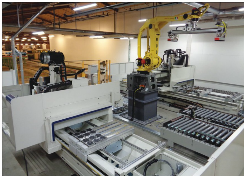
Cellen består af to fuldautomatiske fem-aksede Morbidelli M400 CNC-maskiner, der kontinuerligt arbejder i vekseldrift. Al emnehåndtering ind/ud samt opretning af emner, foretages af robotten midt i cellen.
