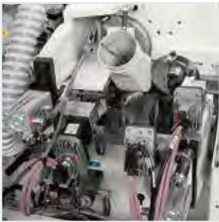
RAS-HP Multiedge 2R edge scraping unit.
