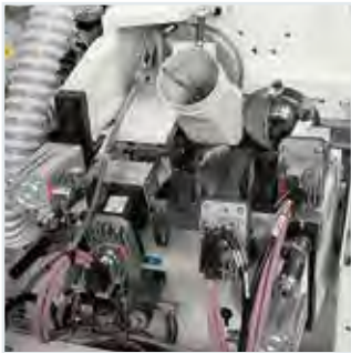
RAS-HP Multiedge 2R edge scraping unit.
