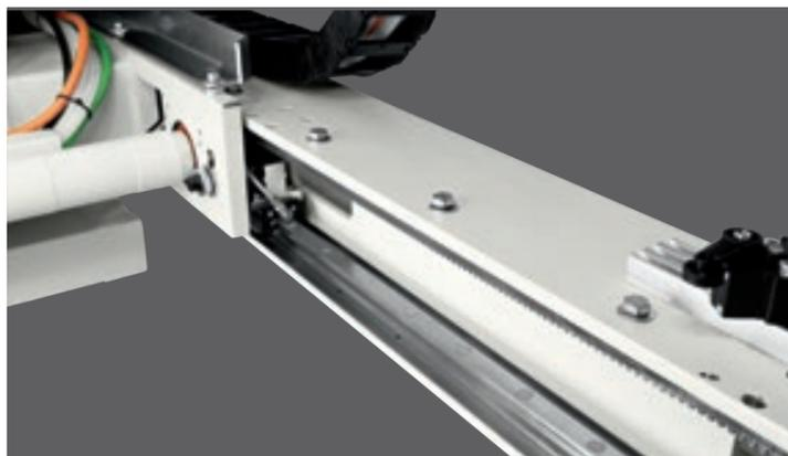
**PRISMATIC GUIDES FOR THE PUSHER: SILENT AND EFFICIENT.**
