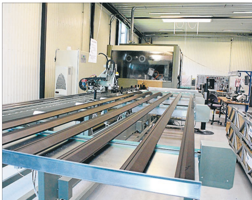
Aluminiumsprofilerne på vej ind i en Emmegi-bearbejdningmaskine. Den del af processen er også automatiseret.
